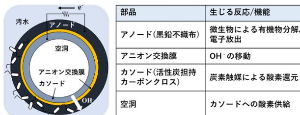
図 1 アニオン交換型エアカソード MFC の構造
