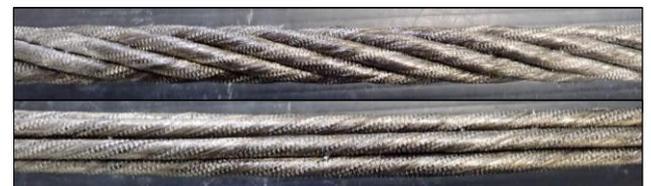
写真 1 ストランド(上)およびストレート(下)
