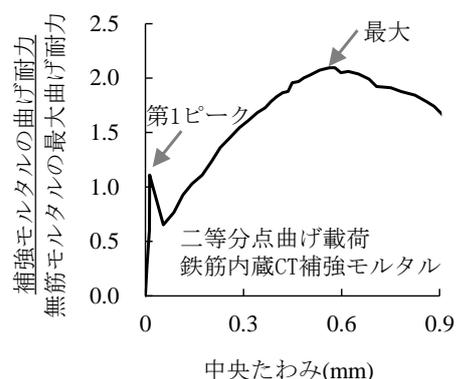
図-1 曲げ耐力-中央たわみ関係の例
