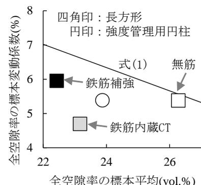
図-2 全空隙率の標本変動係数
