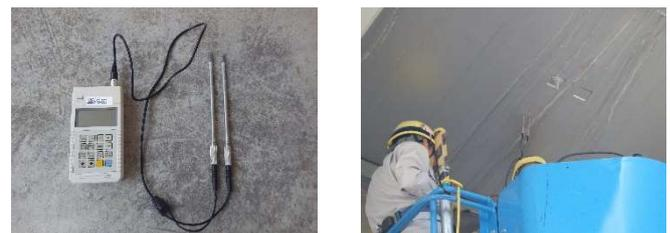
図-3 含水率測定機器と測定状況
