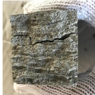
図-6. 圧縮試験後の断面の様子
