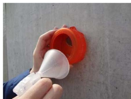
図—3 簡易散水試験
