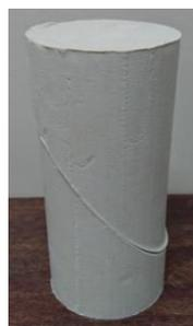
写真-1 亀裂あり供試体
