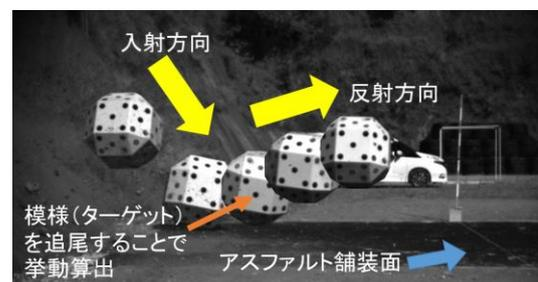
図-3 重錘落下状況 (実験ケース No.2)
