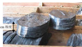
図-4 支持層地盤コア片
