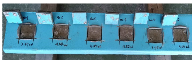
写真-5：プライマーBの剥離状況
