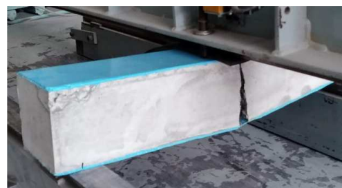
写真-3：ポリウレア樹脂のみの負担状況
