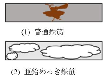
図-7 両鉄筋の腐食の進展
