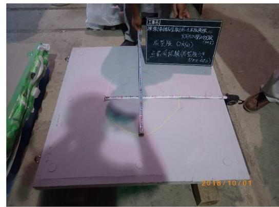
図4 補強繊維成型版の点荷荷による変形
