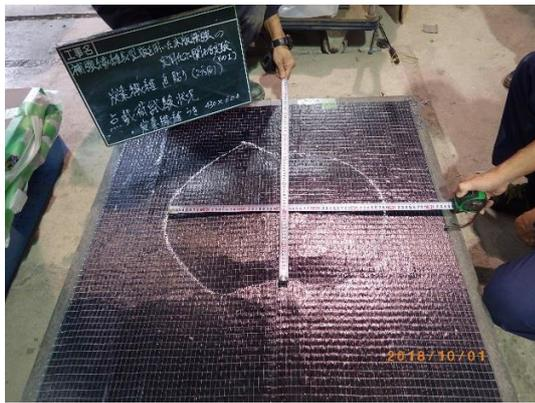
図3 繊維シートの点荷荷による変形
