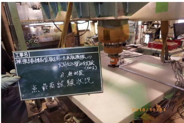
図1 点載荷試験状況
