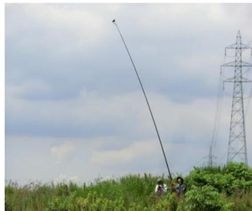
写真-1 遠隔操作カメラでの撮影
