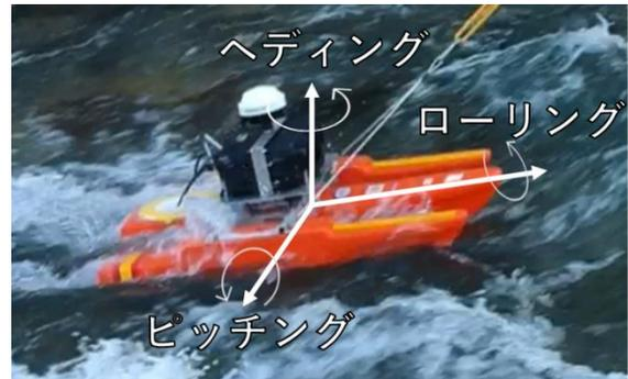
図-2 ADCP の係留ボートの揺動の略図
