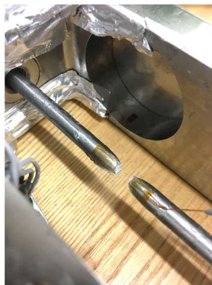
写真-2 鋼材試験片の破断状況(6φ)
