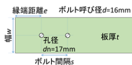
図-1 GFRP 板の概要
