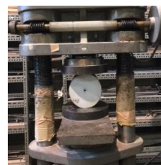
図-2 圧縮試験機によるひび割れ導入
