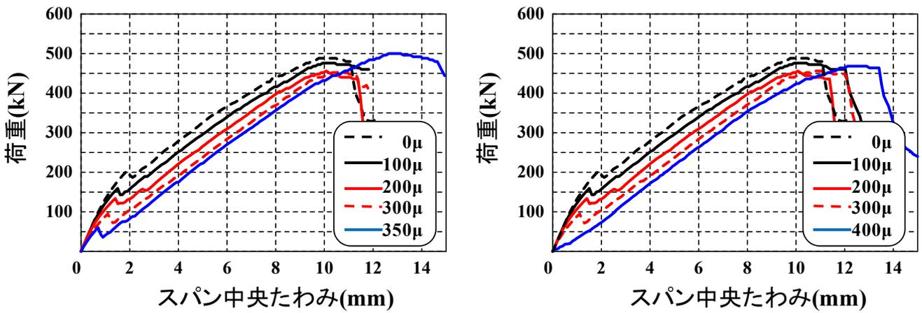
(a) 鉄筋に初期ひずみを導入
