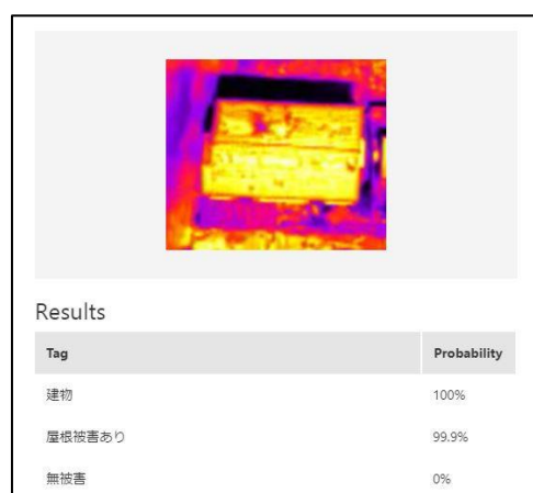
図-2 屋根被害ありの建物の判定結果
