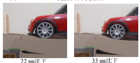
図 7 ラジコンカー設置 (ジオテキスタイル敷設)
