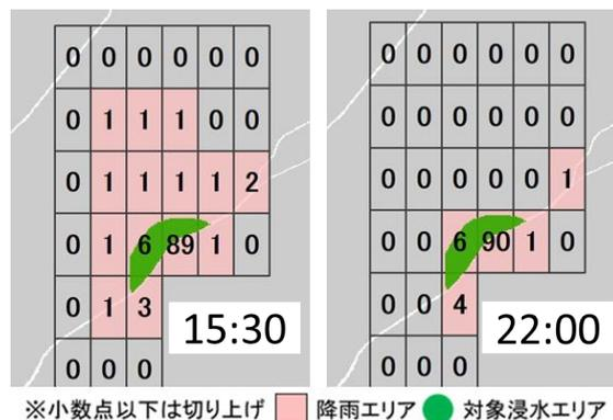
図-4 対象浸水エリアに集積した雨水の降雨エリアと雨水の割合
