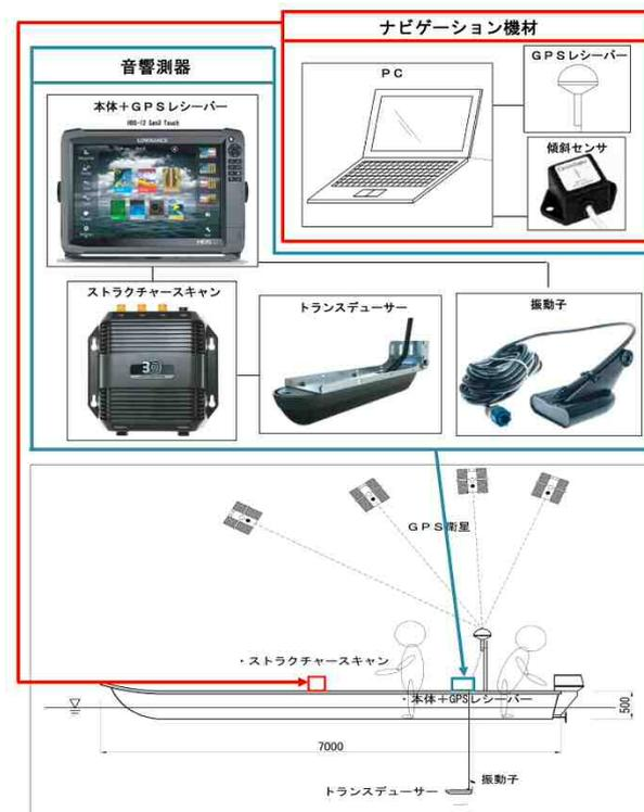
図1 音響測器の機器構成
