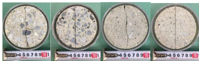
図-2 作製した母材(左から割裂面コンクリート, 切断面コンクリート, 割裂面モルタル, 切断面モルタル)
