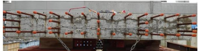
写真-2 端面のひび割れ発生状況
