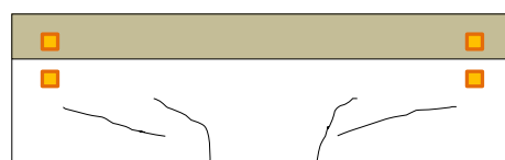
図-4 供試体側面部のひびわれの例
