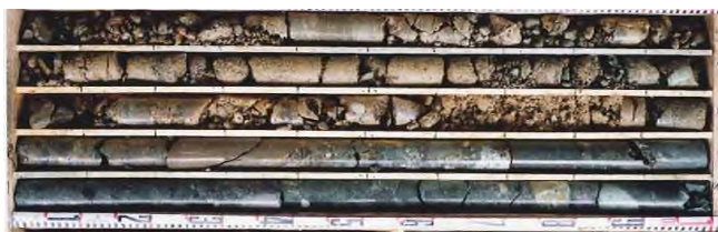
図-1 事前調査の水平ボーリングコア写真
