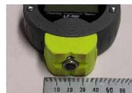
図 2 膜厚計の測定センサー
