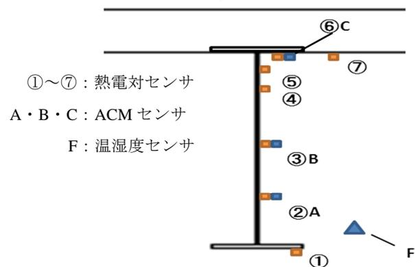
図 2 計測機器の設置位置
