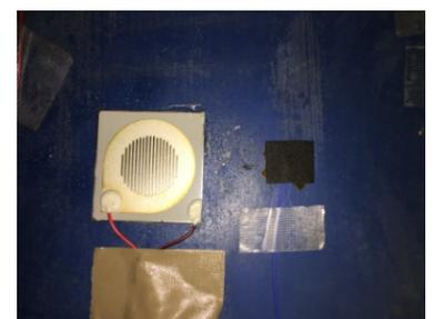
(a)温湿度センサ (b)熱電対(右)と ACM センサ(左)
