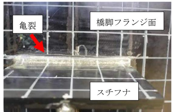
写真-1 実験終了時の破壊状況 (制震モデル)
