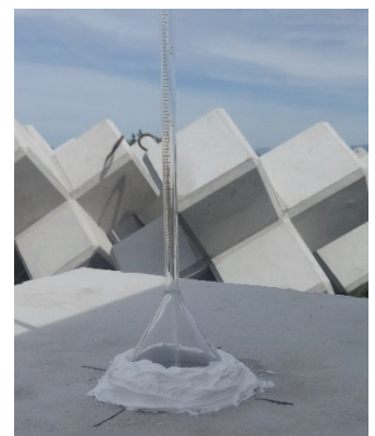
図-2 透水試験の状況（ガラス器具）
