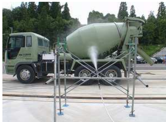
写真-1 生コン車への散水状況
