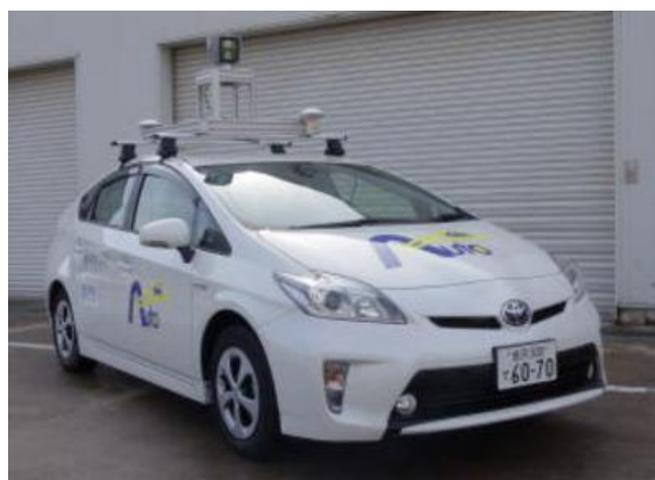
図 1 金沢大学が開発している自動運転自動車<sup>2)</sup>
