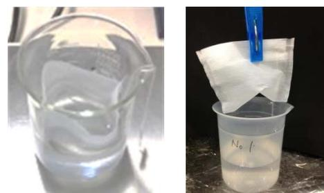
(a) 水溶液への浸漬 (b) 洗濯ばさみを用いた水切り
