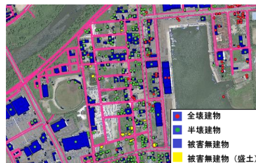
図-7 盛土有り被害無建物の分布
