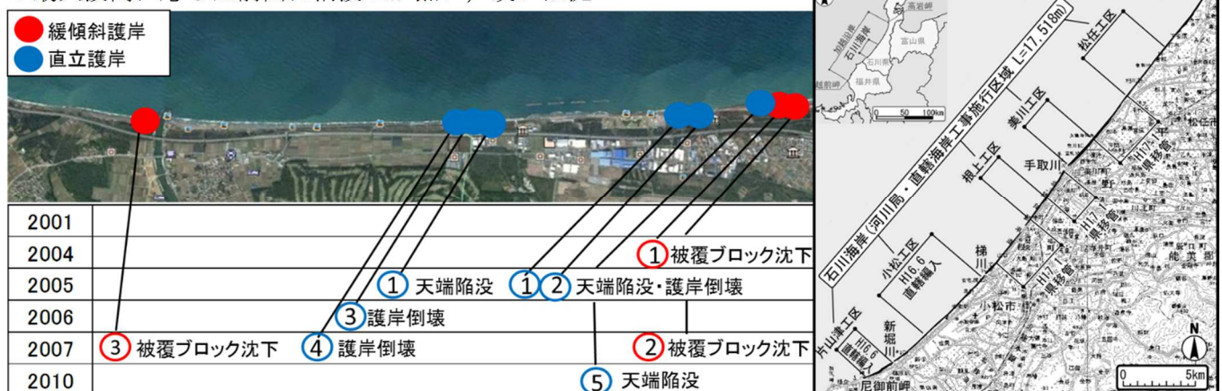
図-1 石川海岸小松・片山津工区での被災発生状況
