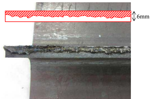
図-6 HWI2-1 の破断面 (図-2(ii)付近)
