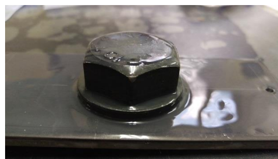
図 2 シリコーン塗布後の供試体
