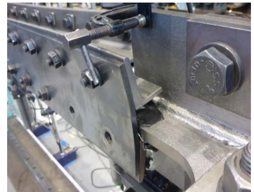
写真 1 端部損傷状況
