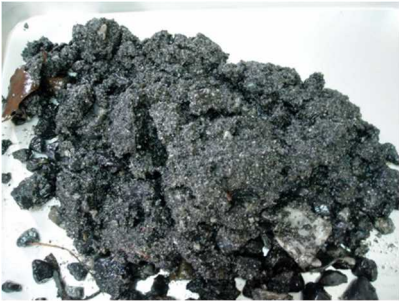
写真-1 実験前の河床土砂 4月10日採取
