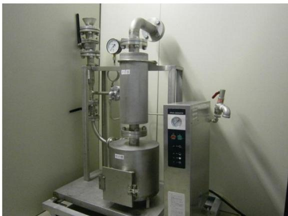
写真1 爆砕処理実験装置
