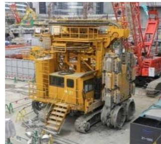
図-4 連壁掘削機
