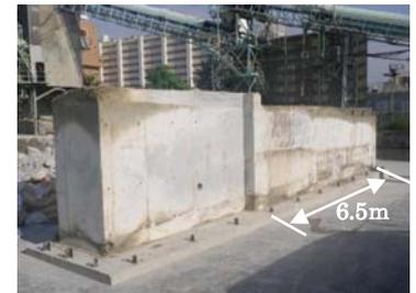
図-9 高流動コンクリート打設試験
