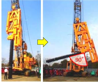
図-7 透し掘り掘削機
