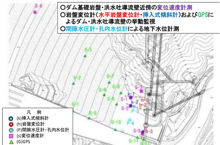
図-3 各種計測機器の配置(一部)
