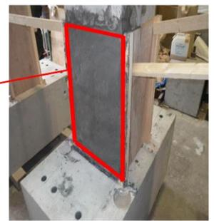
図-2 補修後の供試体
