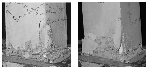
写真-3 荷重履歴 < 8\delta_y \rightarrow -16\delta_y > の -16\delta_y 時の破壊状況 ( s = 120\text{ mm} : 北西面)
