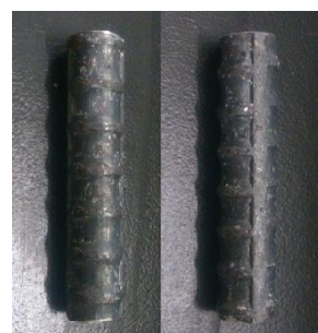
図-4 コンクリート供試体から取り出した鉄筋 (左: 5cm 位置, 右: 8cm 位置)
