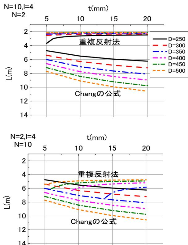
図 2 2層地盤(表層厚 4m)の必要杭長 L のグラフ
