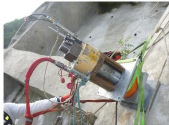
写真-2 荷重計設置状況
