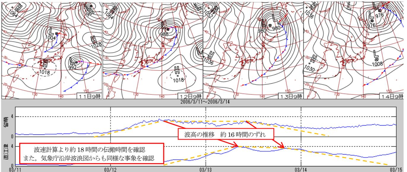
図-2 2006/3/11~14 の 9 a.m.の気象庁による過去の天気図 (上) と 2006/3/11~14 のナウファスによる波高データ (下)
