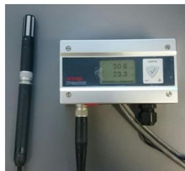
図3 温湿度センサ (左) と温湿度変換機 (右)
