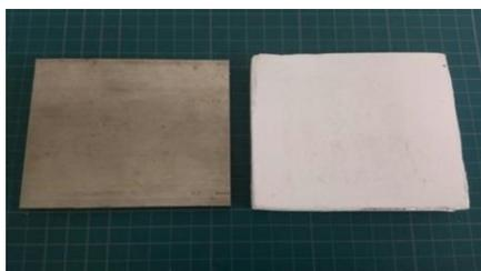
図1 裸の鋼板(左)と断熱塗料を塗布した鋼板(右)
