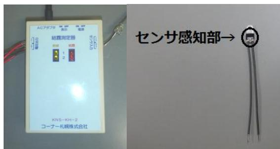
(a)結露測定器 (b)結露センサ
