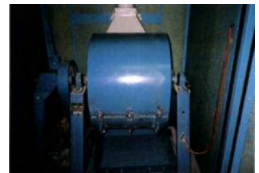
写真-1 ロサンゼルス試験機 (カンタブロ試験実施機械)
